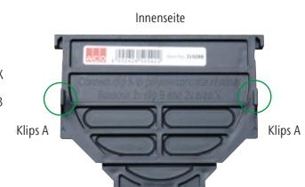
Bereich X und die Klippe B links und rechts mit einem Cutter entfernen. Klippe A in die Rinne einrasten lassen.
