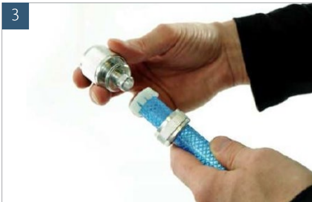
3 Schlauchkupplung fest verschrauben
