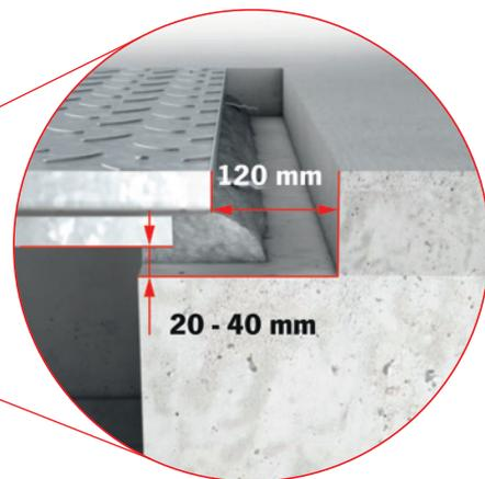
Lichte Maße und hinreichend Überdeckung beachten. Umlaufend ca. 120 mm für die Unterfüllung aus Beton freilassen
