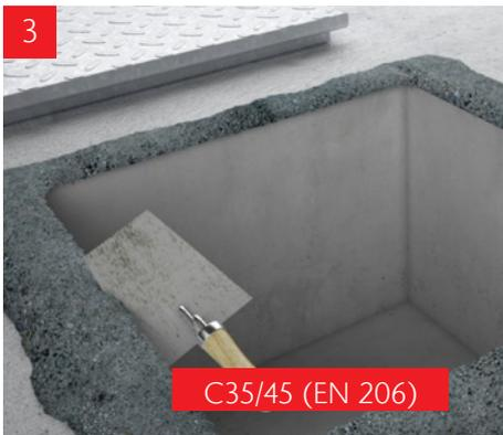
Die eingelegte Abdeckplatte mit Rahmen in C35/45 Betonmischung feucht einlegen
