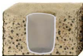
2. Grube ggf. mit zusätzlichem Filtervlies auslegen
