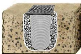
3. Sickerschacht mit Vlies umhüllen, positionieren und die Grube mit Kies/Schotter ausfüllen
