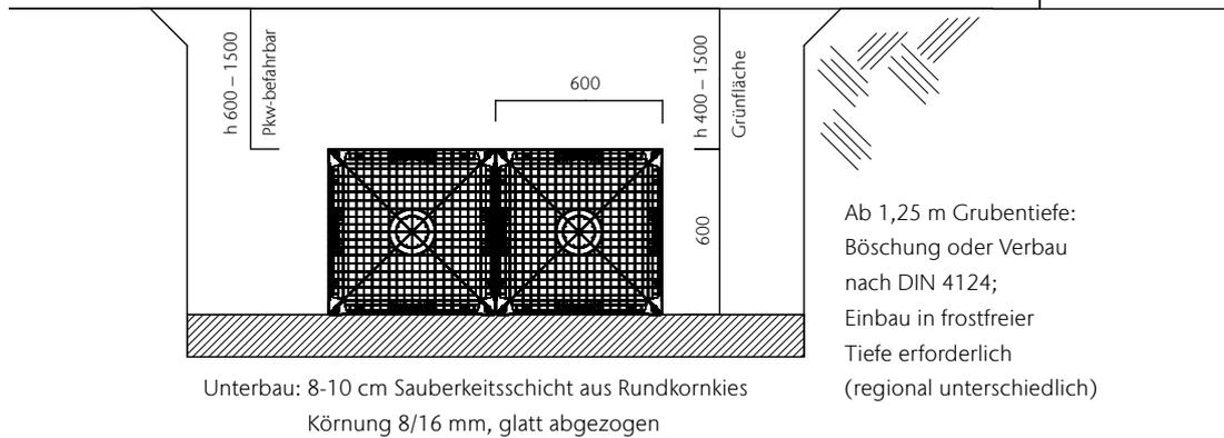
Ist über der Versickerungsanlage eine Rasenfläche geplant, so sollte auf der Versickerung Folie oder ein Lehmschicht aufgelegt werden, da der Rasen ansonsten schnell austrocknen kann.
