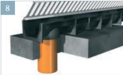
8 Das KG-Rohr an die Kanalisation anschließen.
