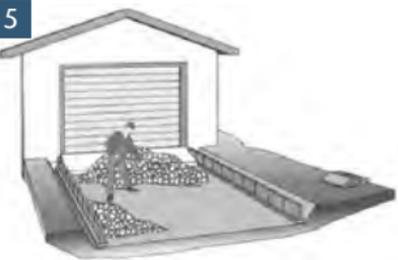
Einbau und Abrütteln der Tragschicht, z. B. bestehend aus Kies/Schotter 2/32-2/45. Die eingebaute Schichtdicke sollte ca. 15 - 45 cm betragen.
