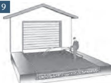
Auf dem Unterbau wird eine ca. 4 cm dicke Ausgleichsschicht als Planum aus Sand oder für besseres Wachstum ein Gemisch aus gesiebttem Kompost mit Sand/Lava aufgebracht. Dünne Rohre dienen als Niveauhilfe seitlich. Darauf wird mit einer Abziehschiene die Ausgleichsschicht glatt gezogen.
