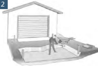
Der Boden wird je nach Belastung der Fläche, z. B. für PKW ca. 20-30 cm tief, ausgehoben. Bei schwer wasserdurchlässigen Böden wie z. B. Ton empfiehlt sich ein Aushub von ca. 40 cm.
