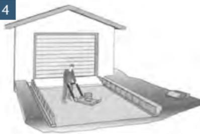
Nach Abbinden der Randbegrenzung wird die Aushubsohle mechanisch verdichtet, z. B. mit einem Rüttler.
