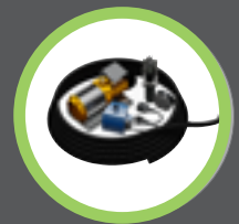
Klarwasserdruckpumpe außerhalb des Tanks mit schwimmender Ansaugung und Trinkwasser-Nachspeisung
