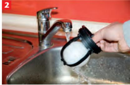
2 Rückstaeinheit und Dichtungen gründlich unter fließendem Wasser reinigen
