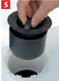
Der Geruchsverschluss kann separat bestellt werden. Beim Rückstauerchluss ist er im Lieferumfang enthalten und zwingend erforderlich. Den Geruchsverschluss eindrücken, bis die Dichtlippe arretiert. Anschließend mit Wasser befüllen
