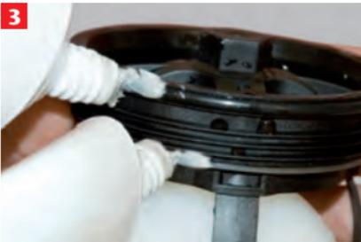
3 Dichtungen an der Rückstaeinheit einfetten
